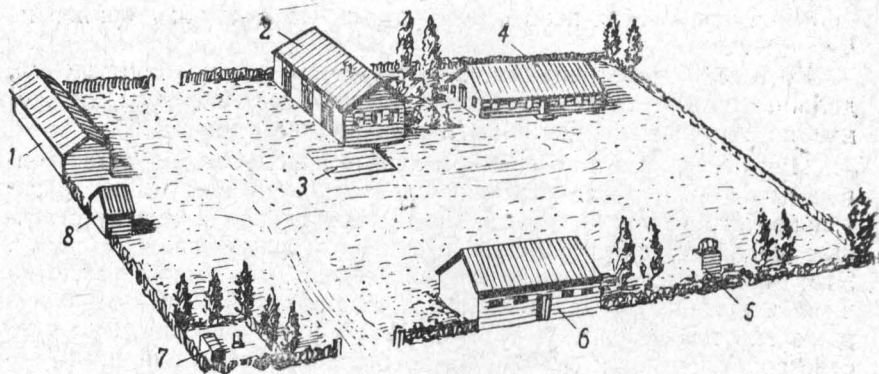
Рис. 3. Общий вид стана тракторной бригады для средней и северной зон: 1 — навес для сельскохозяйственных машин; 2 — мастерская; 3 — контрольная площадка; 4 — жилой дом; 5 — душевая; 6 — конюшня; 7 — погреб для нефтепродуктов; 8 — уборная.
