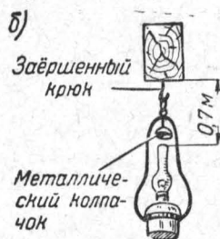
Рис. 15. Правила установки керосиновых ламп: а — стеной; б — подвесной.
